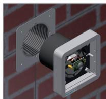
Para iniciar a ligação elétrica, retire os dois parafusos da tampa de proteção elétrica, passe os fios pelo furo central, e faça a ligação. Ajuste a tensão do aparelho na chave seletora (127 ou 220 v) de acordo com sua rede, e fixe a tampa de proteção com os parafusos.
