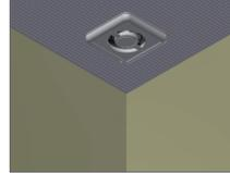
Para finalizar, fixe a moldura quadrada com os parafusos e encaixe as tampinhas.
